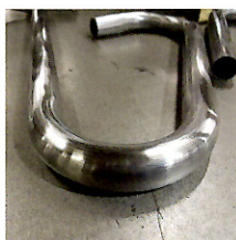
パイプ椅子Re:birthの脚 スチールφ28.6mm、曲げ60R、 140度
