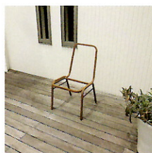
レセプションチェアのフレーム スチール□19mm、溶接18カ所
